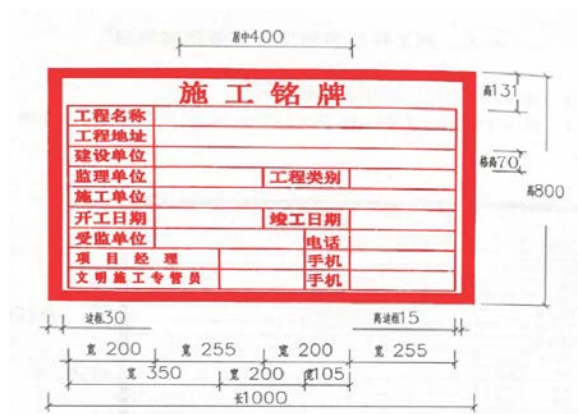
图 11 设置路栏的市政工地施工铭牌
